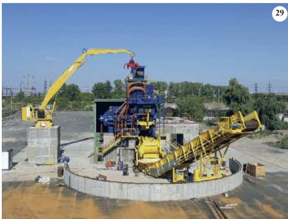
Foto 29 Pressa cesoia inclinata in Argentina. Una delle oltre 500 realizzazioni della Vezzani nel mondo
